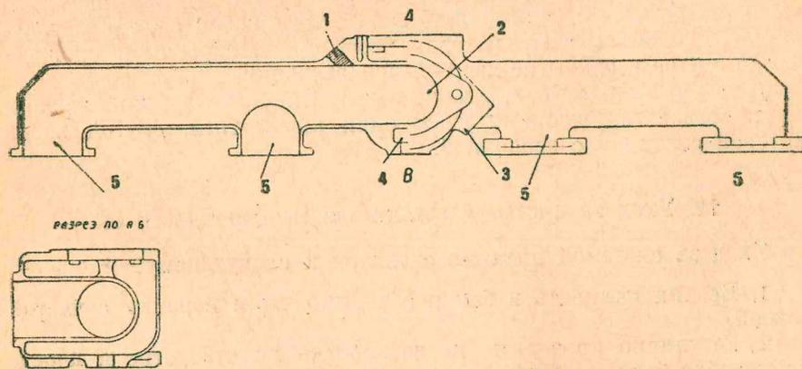
Рис. 25. Всасывающая труба.
