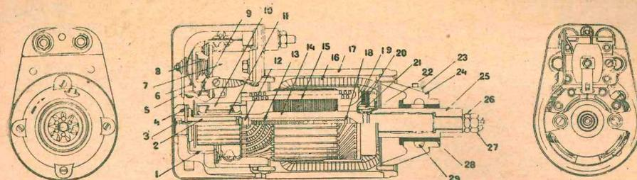
Рис. 37. Общий вид стартера СМА 2,5 л/с.
