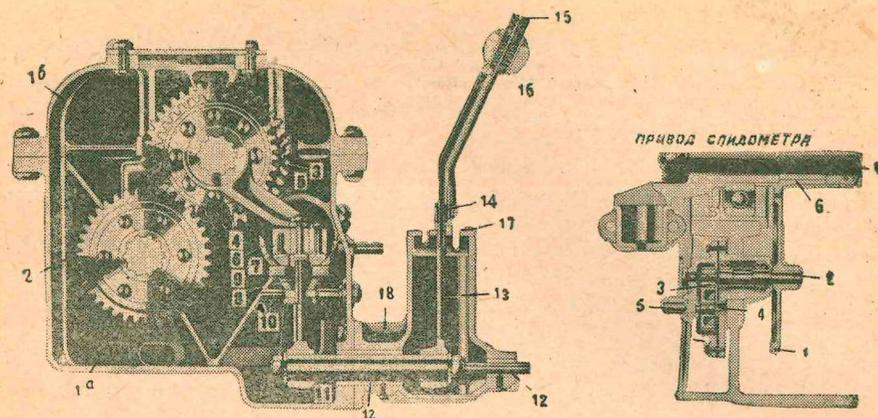
Рис. 47. Коробка передач, поперечный разрез.
