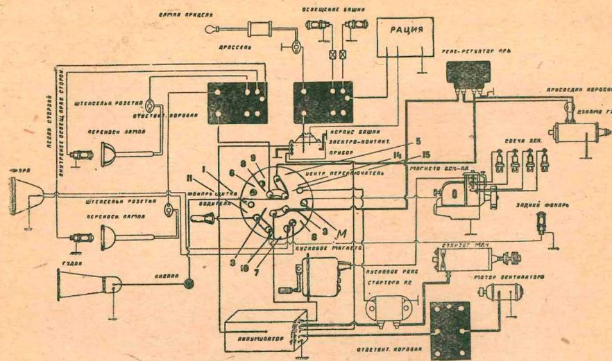
Рис. 34. Схема электрооборудования.
