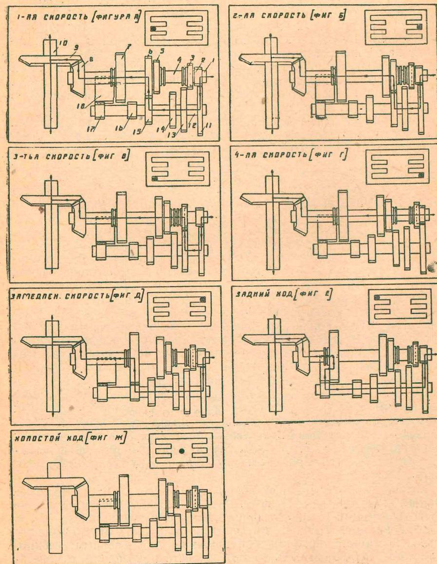
Рис. 48. Схема переключения передач.
