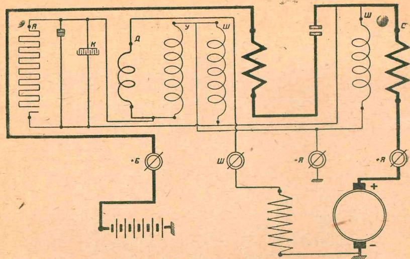
Рис. 36. Принципиальная схема реле-регулятора РРА 250 в.
