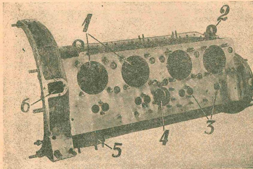
**Рис. 11.** Картер левая половина, наружный вид.
