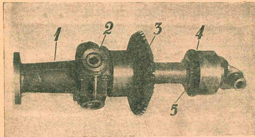
**Рис. 51.** Поперечный валик.
